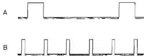
Fig. 6 — Aspetto tipico degli impulsi di sincronismo verticale (A), di lunga durata ed intervallati notevolmente, e di quelli di sincronismo orizzontale, assai più brevi e serrati (B).
