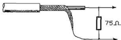
Fig. 47 — Metodo per l'applicazione di un carico anti-induttivo di 75 ohm all'uscita del cavetto di prova di un generatore di segnali ad. Alta Frequenza.
