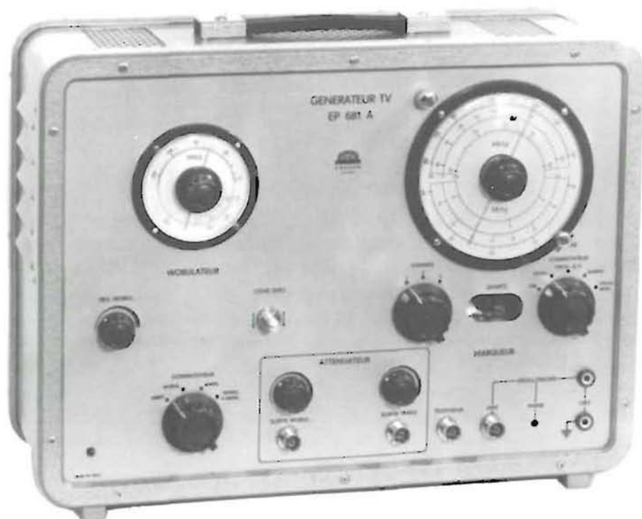
Fig. 16-A — Riproduzione del pannello frontale dello strumento di cui alla figura 15. I comandi sono raggruppati separatamente per le due sezioni « Sweep » e « Marker », ad eccezione degli attenuatori e dei raccordi di uscita, che sono invece raggruppati nel pannellino centrale.
