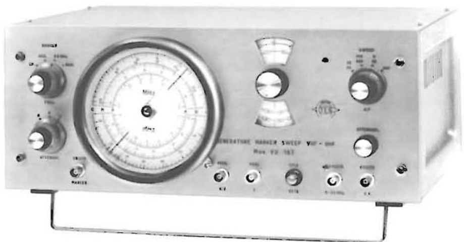
Fig. 16-C — Generatore di segnali video Mod. VU 167, prodotto dalla Tecnic Elettronica System. Questo strumento fornisce segnali di frequenza compresa tra 1 e 30 MHz in conversione e tra 35 ed 85 MHz in fondamentale, oltre che tra 170 e 260 MHz in fondamentale e tra 470 e 780 MHz in terza armonica, all'uscita della sezione « Sweep ». Il « Marker » è in grado di fornire tutte le frequenze di riferimento per l'osservazione delle curve di Alta e Media Frequenza. L'impedenza di uscita del segnale modulato è di 75 ohm.
