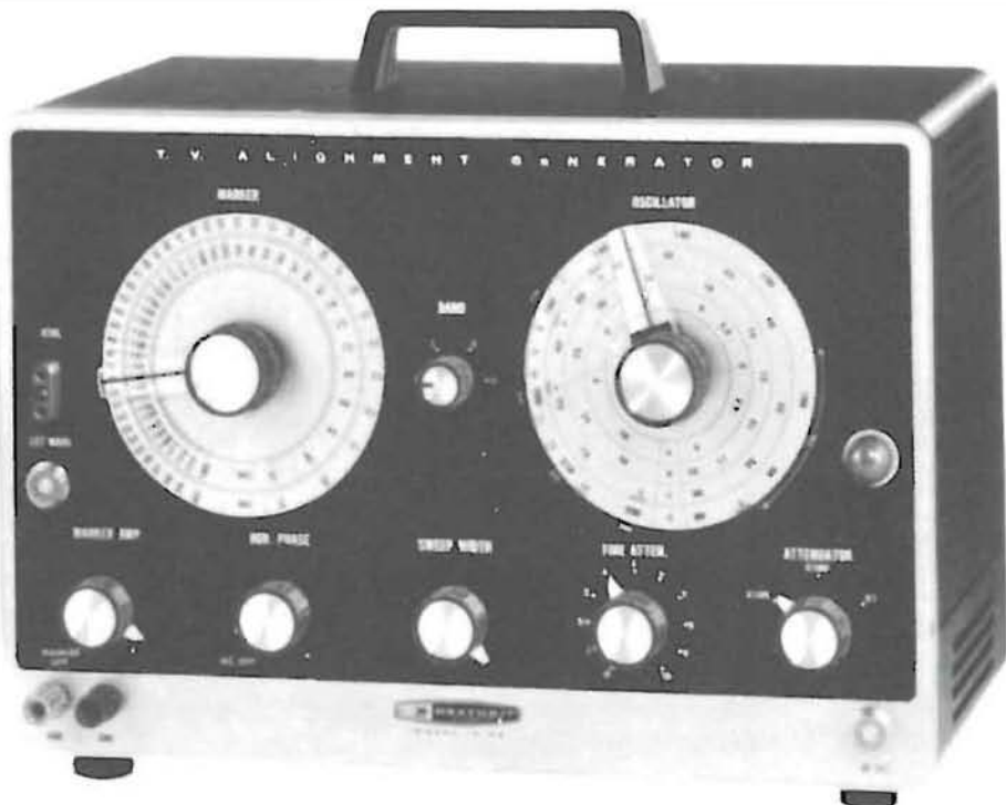
Fig. 16-B — Aspetto del generatore TV Heath-kit modello IG-52: questo strumento è stato realizzato in una forma compatta e di comodo impiego. L'impedenza di uscita è di 50 ohm, ed il segnale ivi disponibile può essere regolato entro tutti i valori dei canali TV ed FM.
